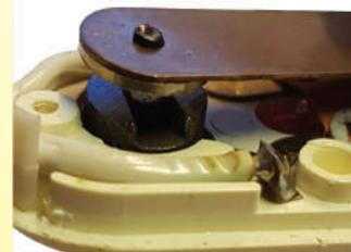
1972 ca Boitier de réglage de la puissance réalisé par Jidé à Limoges sous la marque Jidéstat. **Le plus abouti de tous les systèmes.** De très faible dimensions, il est réglable, et incorporé dans la fiche électrique. C'est le seul modèle comportant un contact à rupture brusque par aimant. Il ne sera pas surpassé par les systèmes électromécaniques développés jusqu'à nos jours. (Collection Ultimheat)
