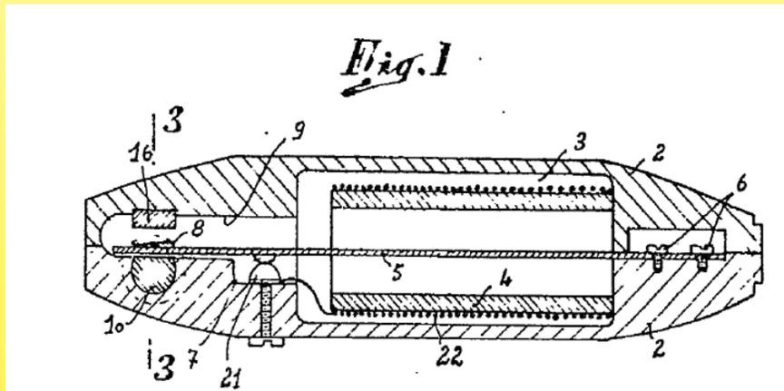
En 1954 Maurice Pierre Marchal de Tisselec, déposa un brevet d'interrupteur à bilame. Ce produit, utilisait une petite résistance en série (N°22) sur la couverture chauffante et échauffait lentement un bilame (5). Le but de cette invention était de réaliser un temporisateur thermique coupant automatiquement le chauffage après une certaine durée. Marchal passa complètement à côté du réglage progressif du chauffage, pourtant très proche de son système
