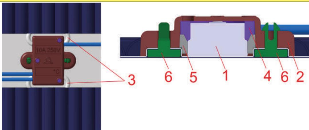
1 : Limiteur 2 : Capot en PA66 3 : Boucles de fils chauffants
