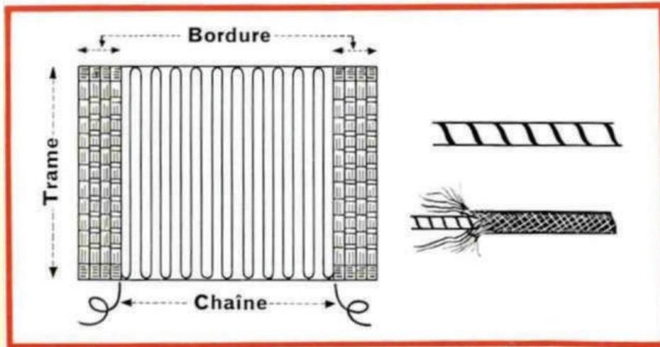
Toile chauffante amiante, et cordon chauffant amiante et tresse
