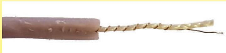
Corde chauffante isolée PVC souple de très faible diamètre (2mm), conducteur unique diamètre 0.11mm en alliage de cuivre (vraisemblablement un maillechort), enroulé sur âme polyester dia 0.5mm, utilisée sur une couverture chauffante General Electric (Angleterre), vers 1962. L'ensemble est très combustible. (Collection Ultimheat)
