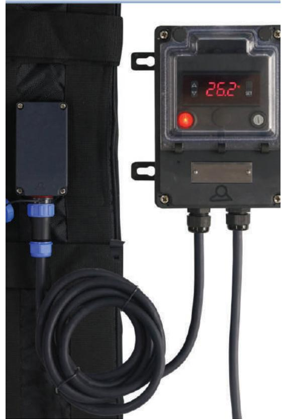
Thermostat électronique à thermistance, simple affichage digital. Action tout ou rien. Montage mural à distance. Comporte une longue sonde plongeante dans le liquide. Peut être utilisé en complément de la régulation de température de surface, pour mettre fin au processus de réchauffage lorsque la température au cœur du liquide est atteinte.
