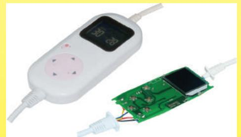
2019 Boitier de commande de couvertures chauffantes à réglage de température à affichage digital par une sonde à thermistance incorporée dans la zone chauffante (Collection Ultimheat)
