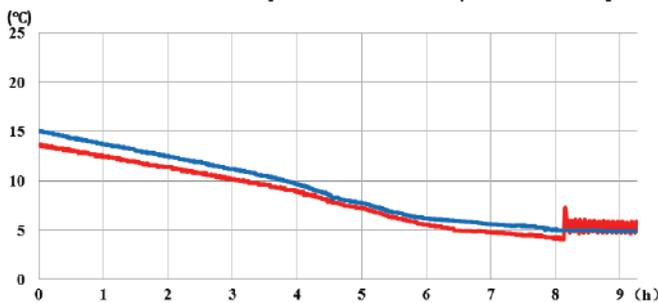
Variation de la température de l'eau dans le réservoir, alors que la température ambiante est de -10°C, avec une charge de 0.05 w/cm<sup>2</sup> (150W). On constate que la température intérieure du réservoir se stabilise à 5°C
