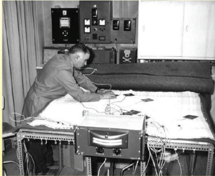
Mesure de la température de surface d'une couverture chauffante (1960 ca, Vedette, Musée Ultimheat).
