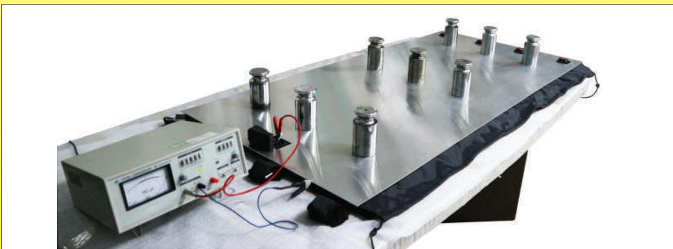
Dispositif de mesure de la résistance d'isolement.
