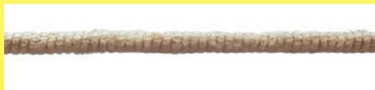
1960 ca corde chauffante Calor, diamètre 1.7mm, fil chauffant unique en nickel chrome diamètre 0.08mm, sur âme en coton légèrement torsadée pour éviter le bouclage. (collection Ultimheat)
