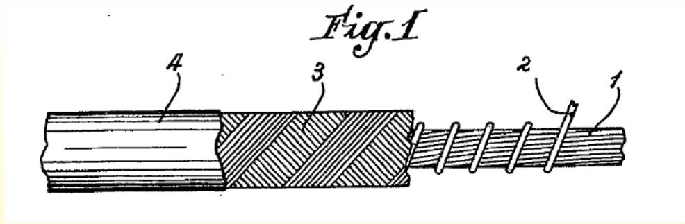
Dès 1949, Tissélec dépose un premier brevet pour une corde chauffante dont le guipage extérieur (3) est recouvert d'un élastomère (4) de type caoutchouc, pvc, ou polyéthylène, afin d'améliorer l'isolement en particulier dans les cas où la couverture est humide. (Brevet FR 982675 enregistré le 13 Juin 1951)
