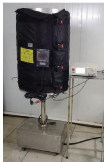
Mesure de la résistance d'isolement après essais IPx6
