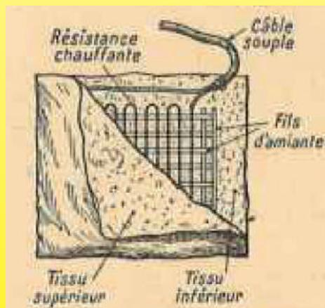
1932, Pour le chauffage individuel proprement dit, on peut citer : Les tissus chauffants sous forme de tapis, chancelières, couvertures, tricot, vestons, ... où la résistance chauffante (50 watts) est isolée par deux fils d'amiante, tissés entre deux épaisseurs d'étoffe (1932 Boll, électricité à la ville et à la Campagne).
