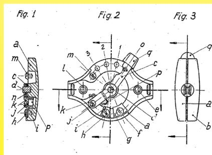
En Janvier 1943, le parisien Roger Marcel Cuhe inventa l'interrupteur rotatif à 5 positions dont 3 allures de chauffe, dans un design qui fut universellement utilisé sur les couvertures chauffantes pendant plus de 30 ans. La position 0 à chaque extrémité du curseur évite des erreurs de manipulation en particulier la nuit. (Brevet Français 890417A)
