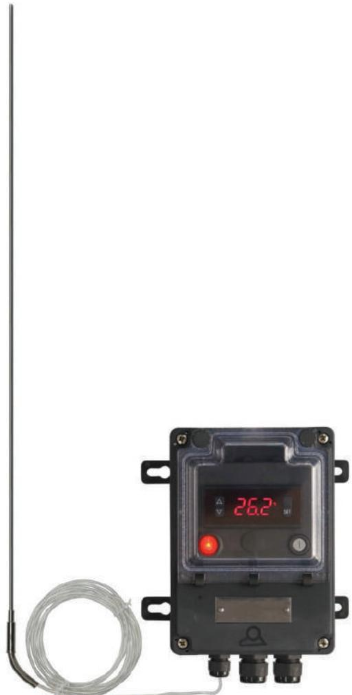
Thermostat électronique, entrée capteur Pt100, action PID avec ajustement automatique des paramètres. Affichage digital double : température mesurée et valeur du point de consigne. Régulation en fonction de la température de paroi du réservoir. Disponible uniquement avec boîtier de contrôle à distance. **Cette version, utilisant un capteur de type Pt100 n'est pas interchangeable avec les modèles de manteaux chauffants avec capteur à thermistance.**
