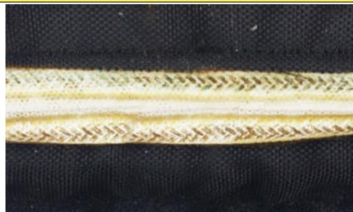
5 minutes à 245°C sur le câble chauffant, le PA66 a fondu, et laisse apparaitre la couche de protection en PTFE qui n'est pas détériorée. La protection du cordon chauffant est toujours réalisée par l'isolation PTFE et silicone.
