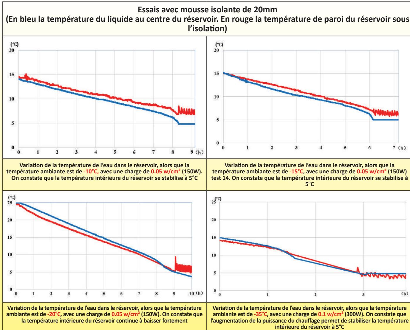
**Analyse des résultats :** Avec une épaisseur d'isolation de 10mm, la charge surfacique de  $0.05\text{W/cm}^2$  est suffisante pour protéger contre le gel un réservoir isolé sur toutes ses faces jusqu'à des températures ambiantes de  $-10^{\circ}\text{C}$ . En augmentant la charge surfacique jusqu'à  $0.1\text{W/cm}^2$  la protection existe jusqu'à  $-15^{\circ}\text{C}$ .
