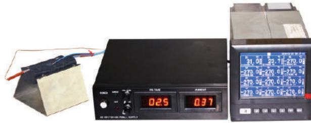
Equipement de mesure de la température de surface en fonction de la charge surfacique de la couverture ou du manteau chauffant
