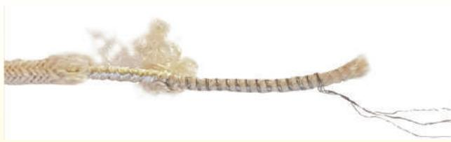
1962 ca, corde chauffante de marque Jidé. Cousue directement sur une des faces de la couverture chauffante, et non plus entre deux tissus, elle comporte 4 conducteurs en nickel spiralés sur une âme en coton, puis recouverts d'un guipage très fin puis d'une tresse en coton. L'ensemble n'est pas étanche et très combustible.
