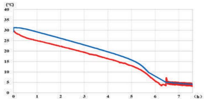
Variation de la température de l'eau dans le réservoir, alors que la température ambiante est de -35°C, avec une charge de 0.1 w/cm<sup>2</sup> (300W). On constate que malgré l'augmentation de la puissance du chauffage, la température intérieure du réservoir continue à baisser lentement
