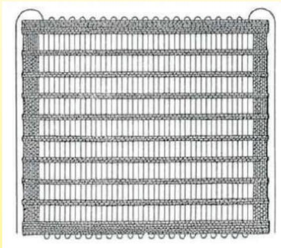
Toile chauffante avec chaîne amiante, utilisable jusqu'à 450°C
