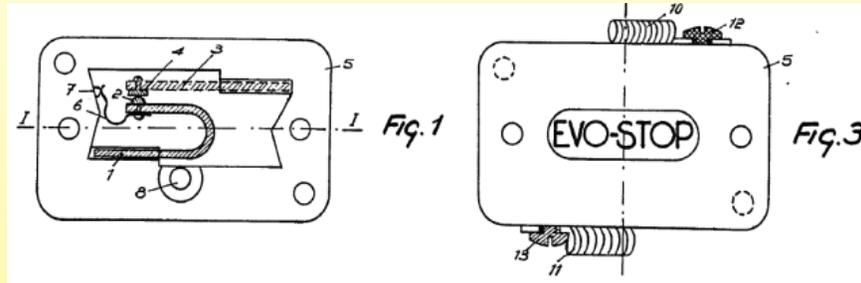
En 1957 Le constructeur de thermoplastes Maurice Georges Moïse Gervaiseau (151, avenue Georges Durand, au Mans), développa, sous la marque Evo-Stop un thermostat à bilame de faible encombrement, dans un boîtier fermé, avec contact à rupture lente améliorée pour pallier aux parasites radio-électriques, destiné spécifiquement aux couvertures chauffantes. (Brevet 1.169253)
